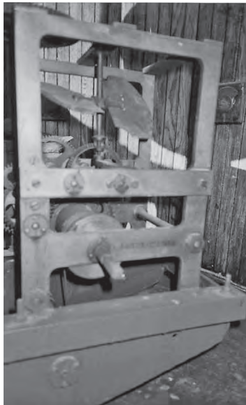
Το σύστημα περιστροφής του φωτιστικού μηχανήματος υπάρχει ακόμα στον φάρο. (Φωτό του 2008)
