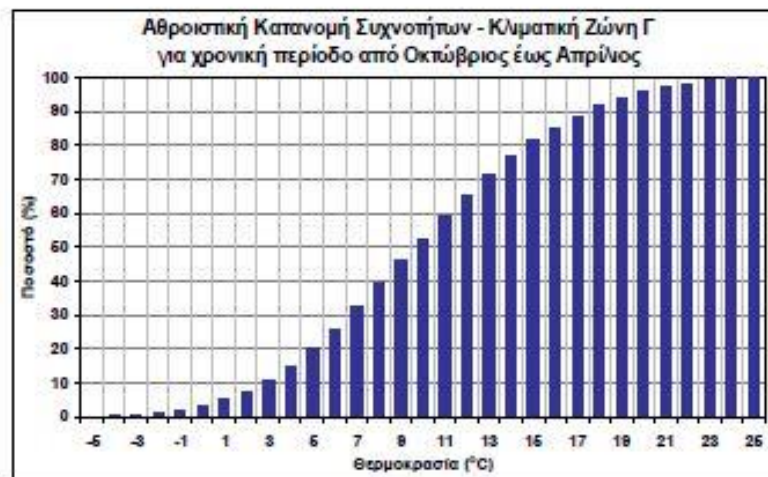
Εικόνα 10: Αθροιστική κατανομή εξωτερικών θερμοκρασιών κατά τη χειμερινή περίοδο για την Κλιματική Ζώνη Γ (Τ.Ο.Τ.Ε.Ε.20701.3-2010)
