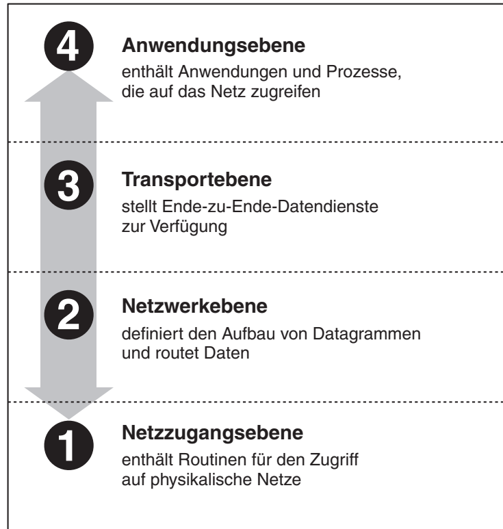
Abb. C.3: Ebenen der TCP/IP-Protokollarchitektur
