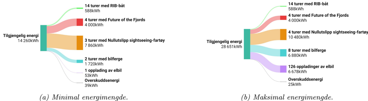
Figur 7.6: Sankey diagram som viser hvilke lastprofiler energimengden fra Scenario 4 gir muligheten til å dekke.
