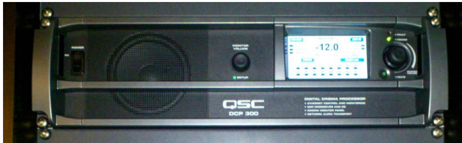
Imagen 195: Procesador de audio DCP300. Display. Fotografía del equipo real en sala
