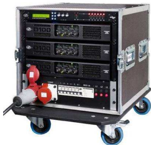
Figura 107. Armarios con procesadores para arrays lineales
