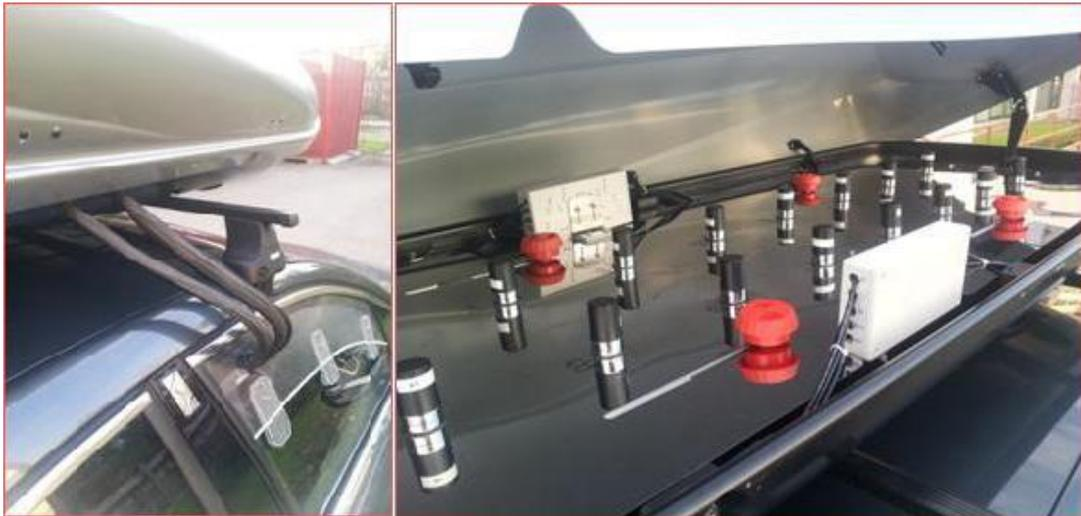
Figura 6.10 Antenas instaladas en el cofre
