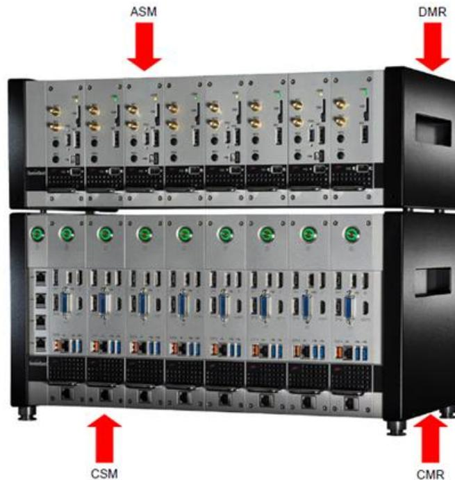
Figura 6.2 Visión general de los componentes del sistema Benchmarker II
