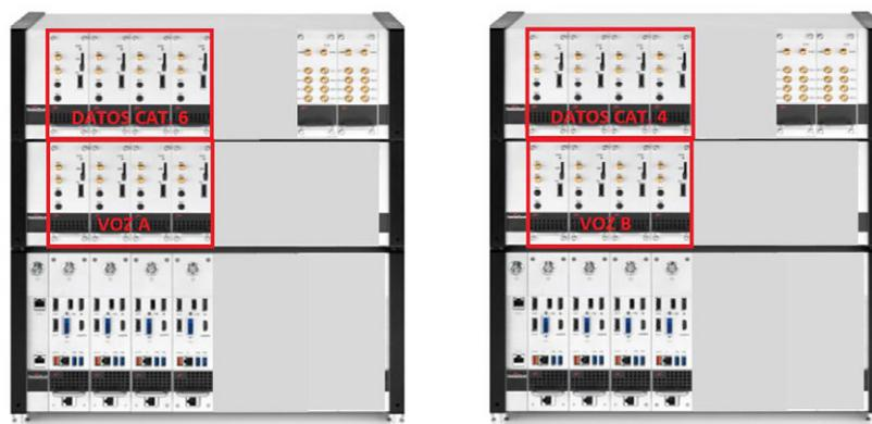
Figura 7.9 Configuración para medida de datos 4G con CA
