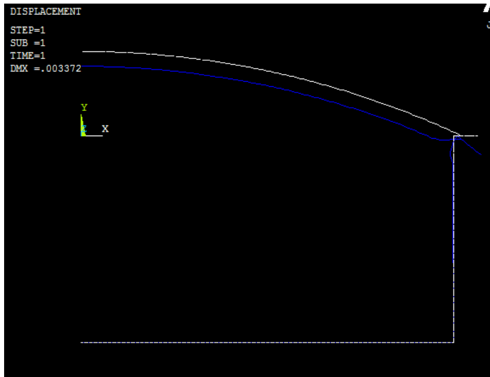
Figura 36: Deformada en carga externa
