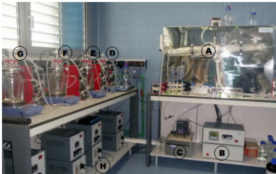
Figura 4 " Simulador dinámico del tracto gastrointestinal SIMGI. A) Estómago; B yC) Cajas controladoras; D) Intestino delgado; E, F y G) Colon ascendente, transverso y descendente, respectivamente; H) Bombas"
