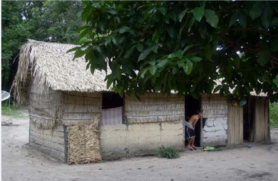
A utilização de esteiras como persianas é muito apropriada para a região amazônica, pois são produzidas com materiais naturais capazes de reter a luz e o calor.
