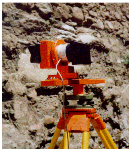
Figura Número 48.- Cámara métrica y objeto del levantamiento
