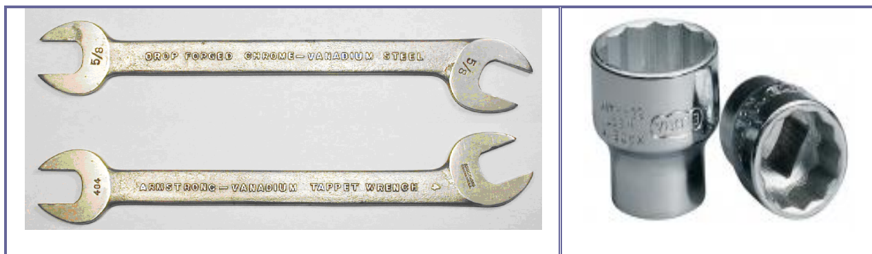
Εικόνα 1.4. Μηχανουργικά εργαλεία πάγκου των τεχνικών συνεργείων, από βανάδιο –χρωμιο-χάλυβες. Αριστερά: "Γερμανικά κλειδιά" για το βίδωμα ξεβίδωμα πολυγωνικών βιδών, "παξιμαδιών". Δεξιά: Πολυγωνικά εργαλεία "καρυδάκια" βιδώματος ξεβιδώματος μεγάλων βιδών "μπουλονιών".
