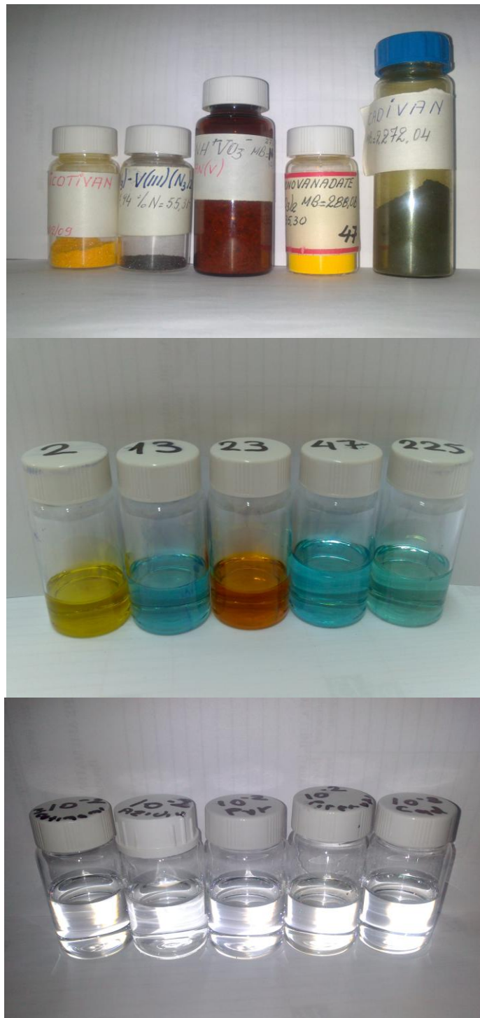
ΕΙΚΟΝΑ 5.0.1: Πάνω τα στερεά βαναδικά συμπλοκα, μέσα στους περιέκτες των. Μέση: Διαλύματα των νέων συμπλόκων σε DMSO και Κάτω: Τα διαφανή διαλύματα των πέντε υποκαταστατων στον ίδιο διαλύτη. Η σειρά των συμπλόκων στις επιμέρους εικόνες είναι ακριβώς η ίδια εξ' αριστερών: Nicotivan (2), Azivan (13), Pygivan (23), Pipervan (47) και Cadivan (225). Οι αριθμοί είναι τυχαίοι, βάσει των αρχικών πρωτοκόλλων συνθέσεως.
