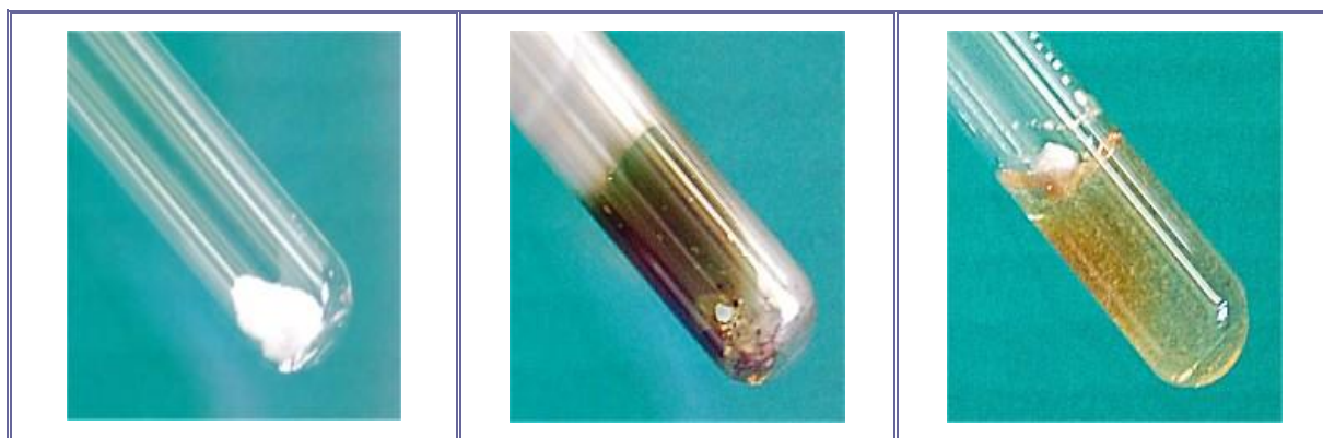
Εικόνα 2.5.6 Αριστερά: Θέρμανση 50-60mg NaN 3 μέσα σε δοκιμαστικό σωλήνα, σε γυμνή φλόγα λύχνου. Μέσον: Μετά τη θερμική διάσπαση ( 2\text{NaN}_3 \rightarrow 2\text{Na} + 3\text{N}_2 ) διακρίνεται κατοπτρική απόθεση μεταλλικού νατρίου στα τοιχώματα του σωλήνα. Δεξιά: Μετά την προσθήκη ύδατος το μεταλλικό νάτριο, ως ειδικώς ελαφρύτερο, ανέρχεται στην επιφάνεια παράγοντας H 2 κατά την αντίδρασή του με το νερό ( 2\text{Na} + 2\text{H}_2\text{O} \rightarrow 2\text{NaOH} + \text{H}_2 ).
