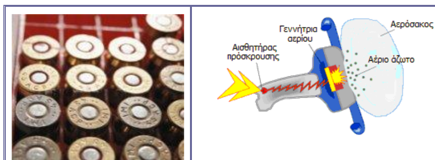
Εικόνα 2.5.21 Αριστερά: Πυροκροτητές και καψύλια. Δεξιά: Η αρχή λειτουργίας του αερόσακου
