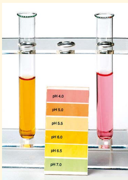
figura 2 Le due provette contengono campioni di acqua piovana non inquinata (provetta di sinistra) e di una pioggia acida (provetta di destra) a cui sono state aggiunte alcune gocce di indicatore universale per evidenziarne il pH. Il campione di acqua piovana non inquinata ha pH attorno a 5, mentre la precipitazione acida ha pH circa 4.
