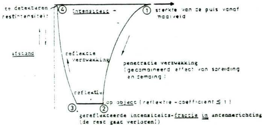
Fig.5.2 : Schematisch verloop van penetratie, reflectie en demping.
