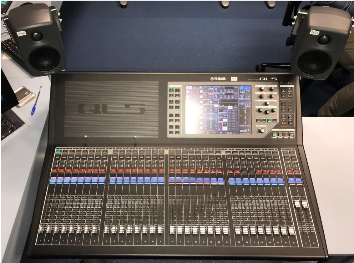
Figura 52: Ejemplo de instalación de las escuchas Genelec 8010A con la mesa de mezclas Yamaha QL5
