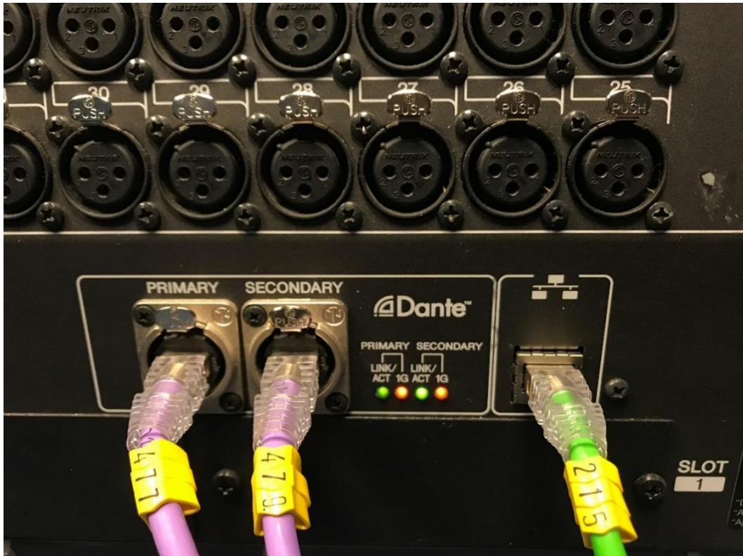
Figura 54: Ejemplo de conexiones DANTE y Ethernet en una Yamaha QL5
