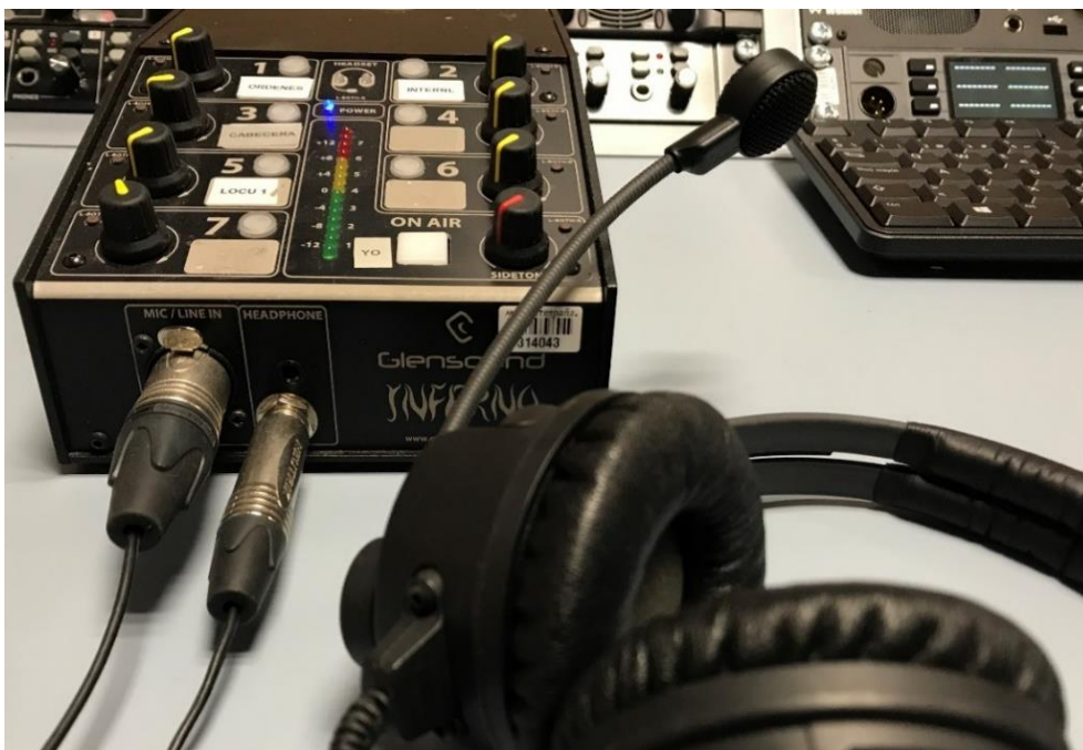
Figura 49: Ejemplo de conexión de unos micro-cascos a una mesa de comentarista
