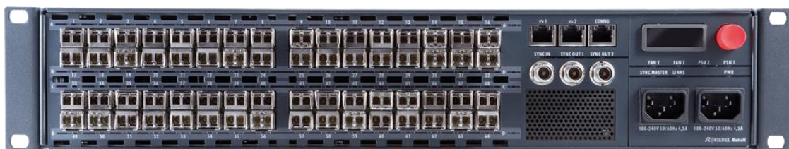
Figura 11: Vista del panel de conexiones de un MetroN de Riedel
