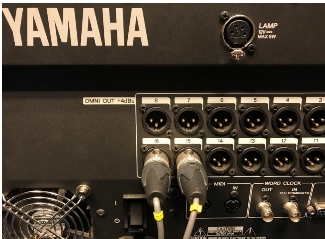
Figura 51: Ejemplo de conexión de unas escuchas a las salidas OMNI de una Yamana QL5
