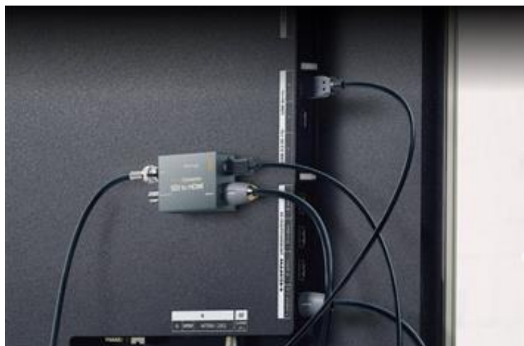
Figura 32: Ejemplo de utilización del Micro Converter SDI to HDMI de Blackmagic
