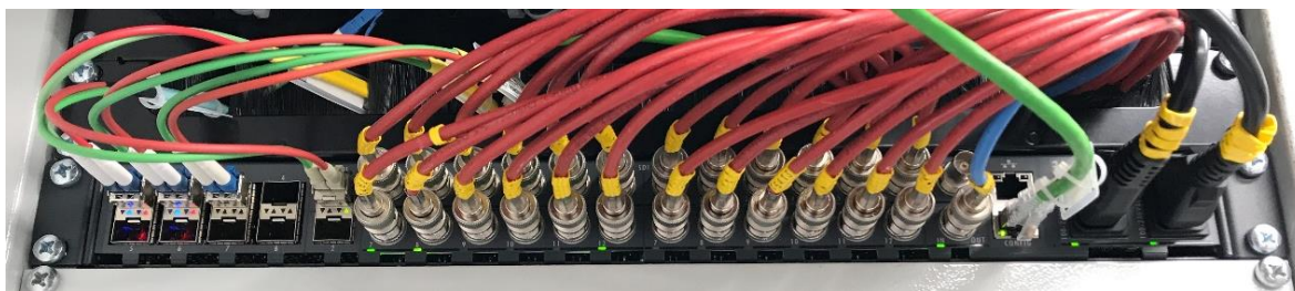
Figura 47: Ejemplo de conexionado de un MicroN (cable coaxial de color rojo para vídeo digital)
