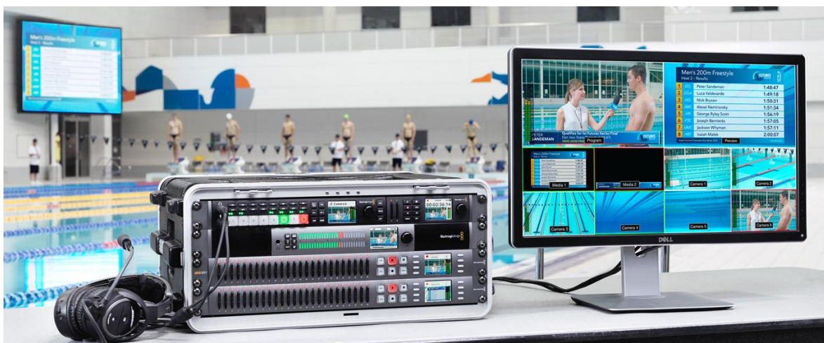
Figura 28: Ejemplo de Multiview utilizando un monitor informático con entrada HDMI
