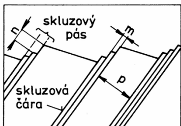
Obr. 51 Skluzová deformace monokrystalu – schéma (řádově rozměry m \approx 10^2 , n \approx 10^3 , p \approx 10^4 atomových vzdáleností)
