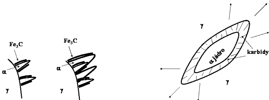
Obr. 93 Schéma vzniku horního (vpravo) a dolního baintu (vlevo)
