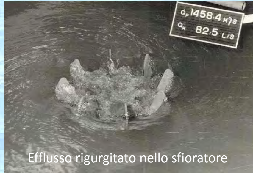
Modello del calice con setti antivortice e prese piezometriche
