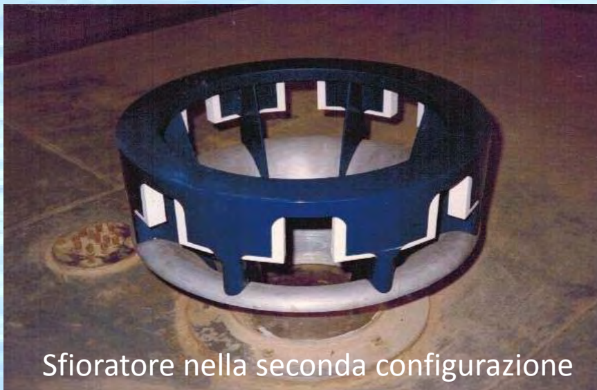
Modello del calice con setti antivortice e prese piezometriche
