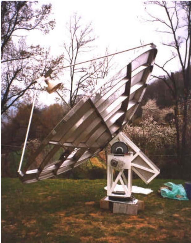
Figura 13 : antenna e meccanismo di movimentazione, assemblati a terra.
