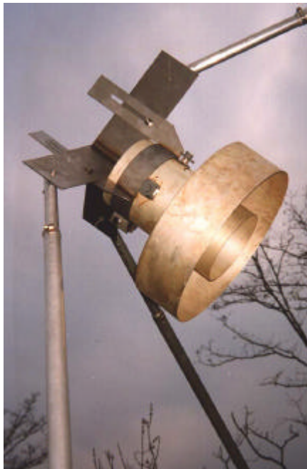
Figura 11 : dettaglio dell'illuminatore e suo supporto.
