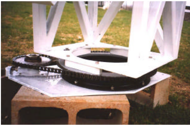
Figura 15 : particolare del meccanismo di rotazione di azimuth.
