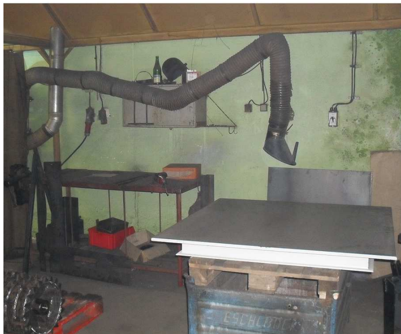
Obr. č. 19 – Svařovací box s místním odsáváním
