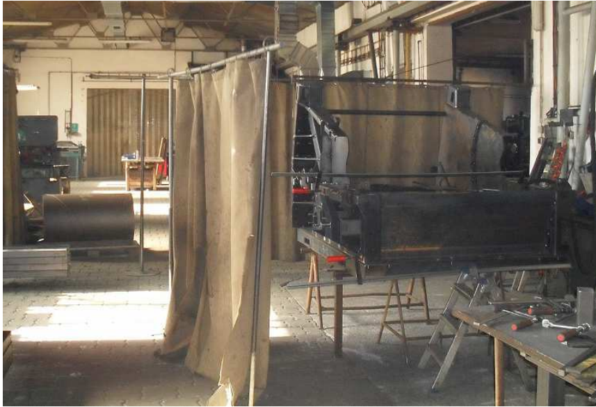
Obr. č. 18 – Použití přenosných clonících stěn u otevřeného pracoviště
