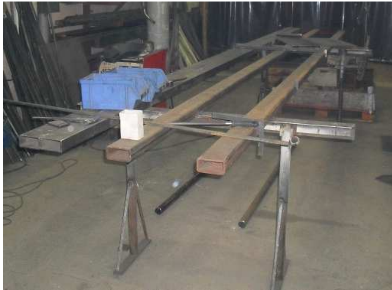
Obr. č. 27 – Přípravek pro kompletaci zábradlí s možností přestavby
