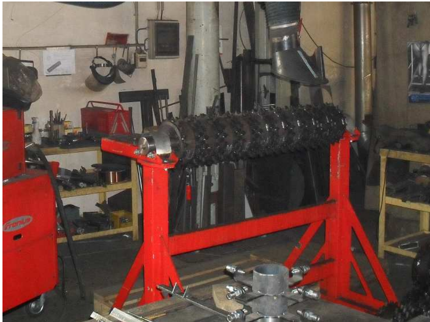
Obr. č. 20 – Přípravek pro kompletaci podávacího bubnu
