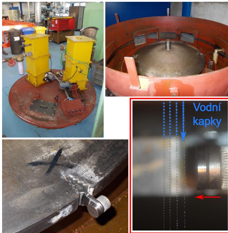
Obr. 4.9: Na fotografiích je zachycen přístroj pro analýzu eroze materiálu vodními kapkami spolu s uchycením vzorku k otočnému disku. V červeně zvýrazněné části je naznačen směr pohybu vzorku a proud kapek v jeho trajektorii.
