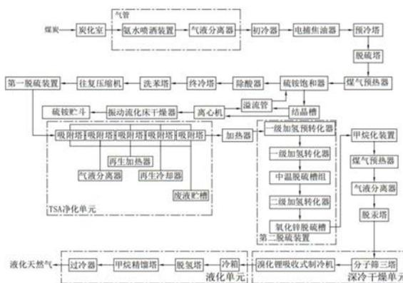
1. 一种液化天然气的生产系统,其特征在于,包括与炭化室依次连接的初冷器、电捕焦油器、预冷塔、脱硫塔、煤气预热器、硫铵饱和器、除酸器、终冷塔、洗苯塔、往复压缩机、第一脱硫装置、TSA净化单元、加热器、第二脱硫装置、甲烷化装置、煤气预热器、气液分离器、脱汞塔、深冷干燥单元和液化单元;
