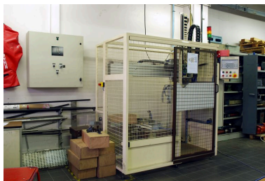
Machine à organiser des cartons sur une palette Phot. Catherine Guégan IVR82_20116901934NUCA
