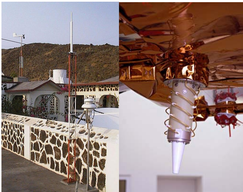
Obrázek D3.9.8: Anténa DORIS – vysílač na Zemi (stanice Socoro, Mexico), vlevo, a přijímač na družici, vpravo.
