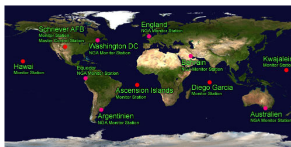
Obrázek 4.3: Segmenty systému GPS NAVSTAR, monitorovací stanice
