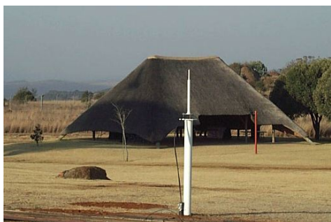
Obrázek 3.10: Vysílač systému DORIS a rozložení permanentních stanic technologie DORIS
