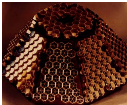
Obrázek 4.1: Beacon C (BE-3), segmenty koutových odrážeců
