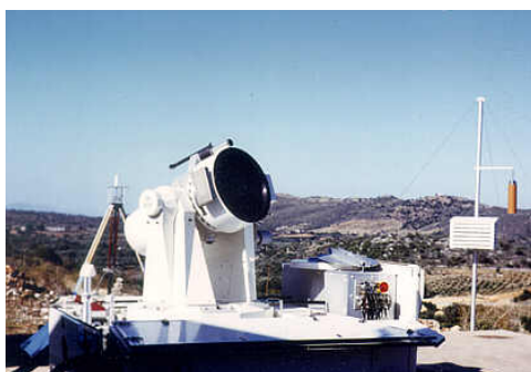
Obrázek 3.4: – Lasarový družicový dálkoměr s azimutální montáží
