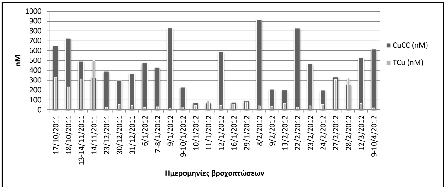
Σχήμα 7.20. Συγκεντρώσεις CuCC και TCu σε όλα τα δείγματα βρόχινου νερού που συνελέγησαν από την περιοχή του Ηρακλείου (CuCC: 67-918 nM και TCu: 16-500 nM)
