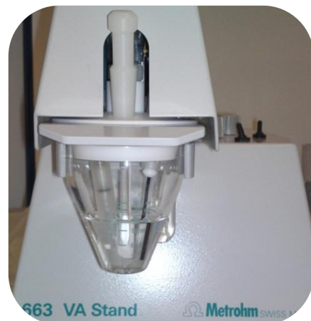
Εικόνα 6.3. Ηλεκτροχημικός αναλυτής ECO-CHEMIE συνδεδεμένος με κυψελίδα μέτρησης τριών ηλεκτροδίων της Metrohm (VA 663) (αριστερά) και κυψελίδα μέτρησης ηλεκτροχημικού αναλυτή μαζί με τα ηλεκτρόδια (δεξιά)
