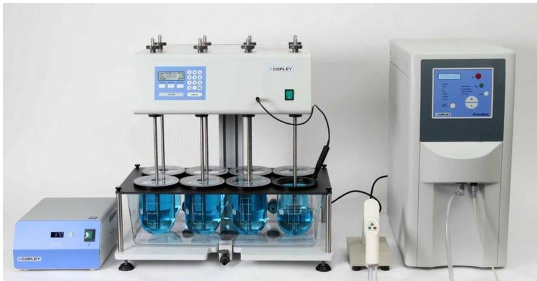
Εικόνα 6.5: Συσκευή Dissolution για τον έλεγχο της διαλυτότητας των σκευασμάτων
