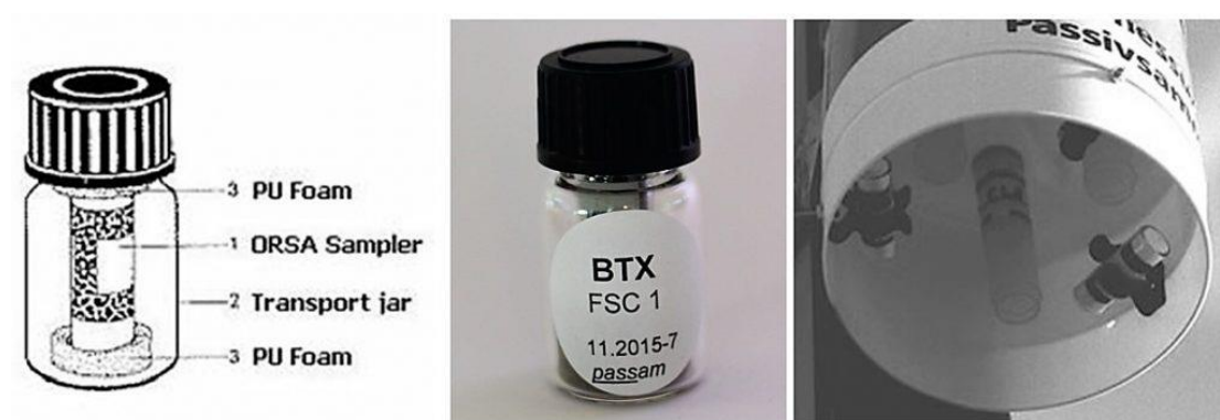
Εικόνα 3.10: Παθητικός δειγματολήπτης VOC's (polar-nonpolar) και ειδικά σχεδιασμένος σκελετός προστασίας.
