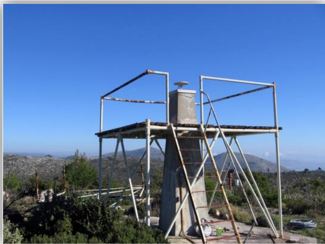
Εικόνα 1.6 Το βάθρο, στο Κέντρο Δορυφόρων Διονύσου του Εθνικού Μετσόβιου Πολυτεχνείου, αφητηρία του Ελληνικού Γεωδαιτικού Συστήματος Αναφοράς του 1987
