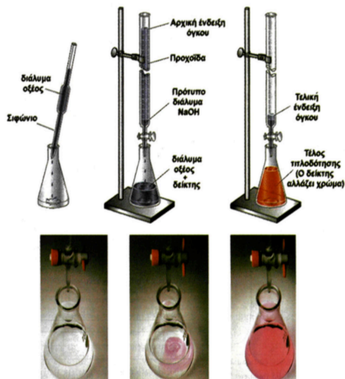
ΣΧΗΜΑ 2.1 Διαγραμματική παρουσίαση της διαδικασίας προσδιορισμού οξικού οξέος στο ξίδι: α) εισάγεται με το σιφώνιο στην κωνική φιάλη ορισμένη ποσότητα του διαλύματος («άγνωστο») β) δείκτης προστίθεται στο «άγνωστο» και ακολουθεί προσθήκη σιγά – σιγά του πρότυπου διαλύματος NaOH με τη βοήθεια της προχοΐδας γ) η χρωματική αλλαγή του δείκτη φανερώνει το τέλος της τιτλοδότησης. Στην κάτω σειρά εικόνων, φαίνεται η αλλαγή χρώματος του δείκτη φαινολοφθαλεΐνη.
