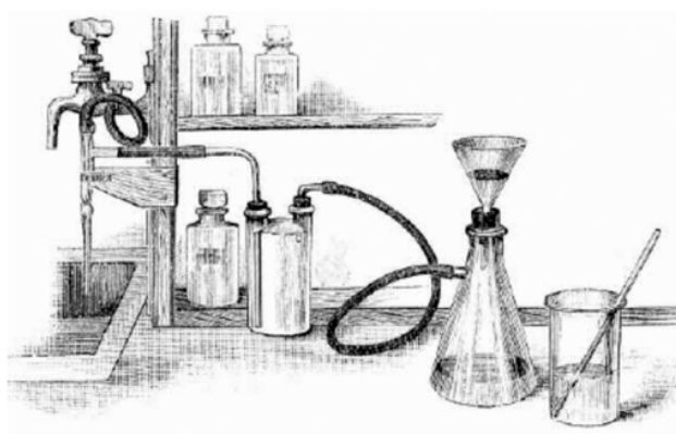
Εικόνα 43: Αντλία νερού για δημιουργία νερού συνδεδεμένο με χωνί Hirsch 61
