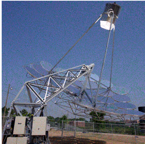
Figure 2.28 : Le système Parabole/Stirling par CPG de 7 kW e
