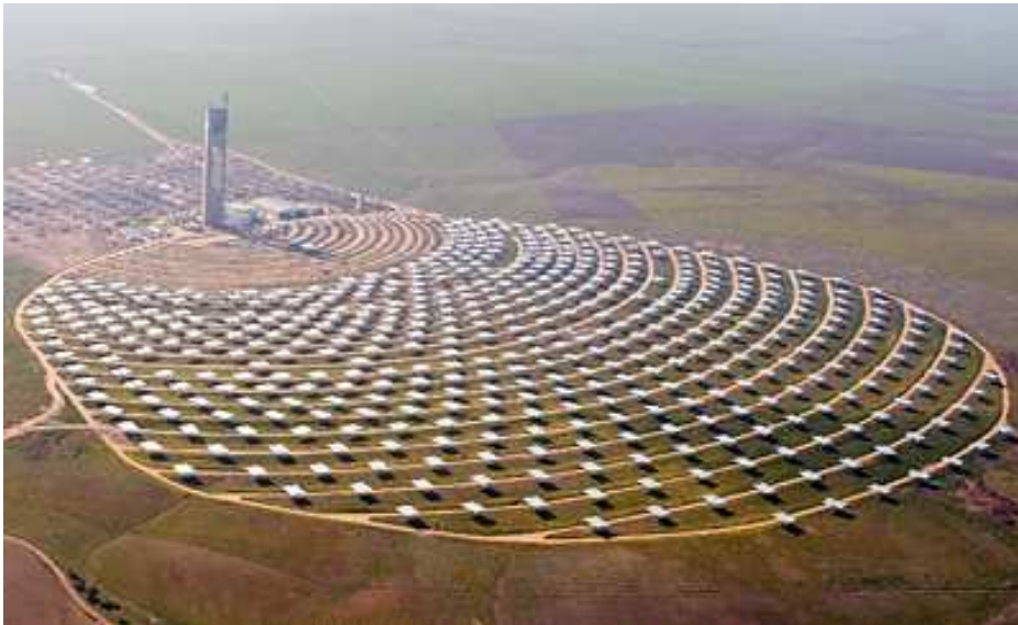
Figure 1.1 : La centrale à tour PS10 en fonctionnement près de Séville (Espagne)
