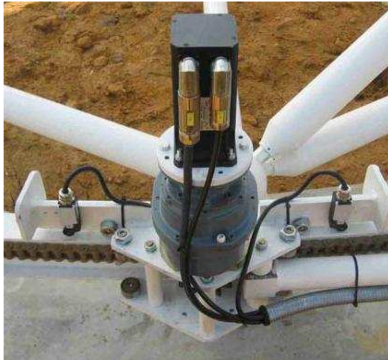
Figure 3.4 : Système de déplacement servomoteur/chaîne/rail sur l'axe d'azimut
