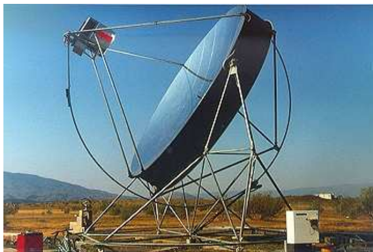
Figure 2.29 : Le système DISTAL II par SBP de 10 kW e à Almería
