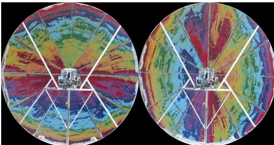
Figure 4.7 : Photographie de la cible réfléchi par la parabole ; à gauche avec des bandes horizontales, à droite avec des bandes verticales
