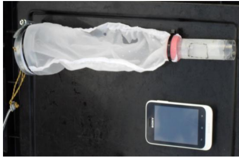
Εικόνα 2. Το φυτοπλαγκτονικό δίχτυ που κατασκευάσαμε
