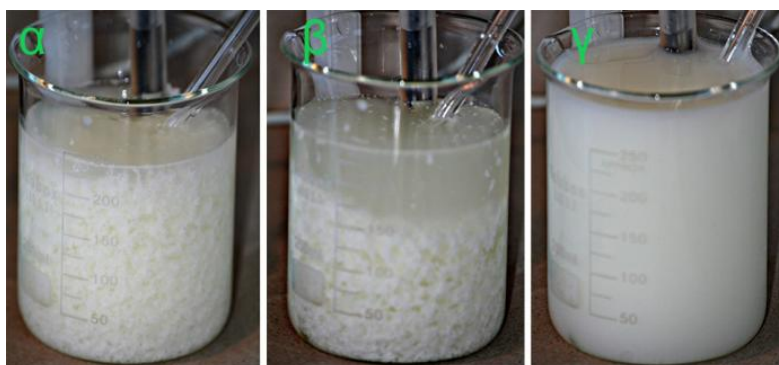
Εικόνα 2. α. Σε pH=4,8 η καζεΐνη είναι αδιάλυτη, β. μετά από πέντε λεπτά σε ηρεμία κατακρημνίζεται και γ. το pH επανέρχεται στην αρχική τιμή οπότε η καζεΐνη επαναδιαλυτοποιείται
