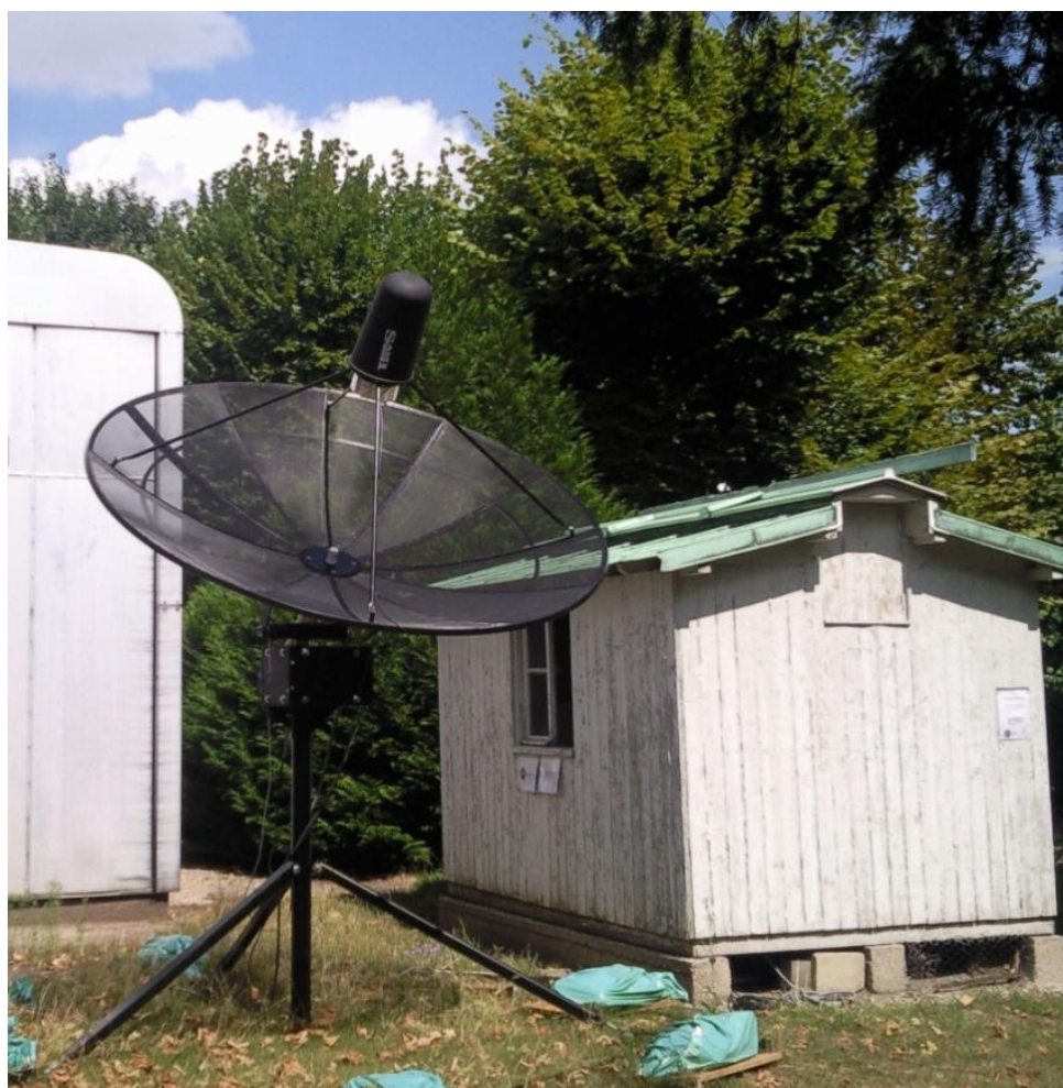
Le radiotélescope (pointé sur le Soleil) et la cabane abritant l'ordinateur qui le contrôle. On voit que l'ombre du récepteur est au centre de la parabole, signe que l'offset entré correspond à une position grossièrement correcte.
