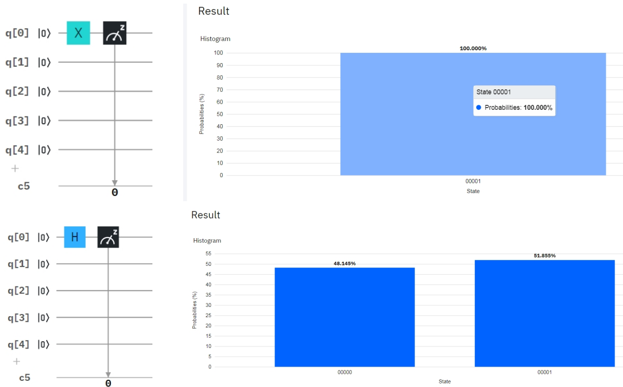
Obrázek 10.1: Snímky z editoru IBM-Q Circuit composer pro X a Hadamardovu bránu. Vpravo jsou pak pravděpodobnosti výsledků měření. U Hadamardovy brány by pravděpodobnosti naměření hodnoty 0 i 1 měly být stejné (0,5). V simulaci to takto přesně nevychází - to je způsobeno jednak nedokonalostmi ve skutečné fyzikální realizaci kvantového počítače IBM-Q, jednak omezeným počtem pokusů (1024), ze kterého jsou pravděpodobnosti rekonstruovány.
