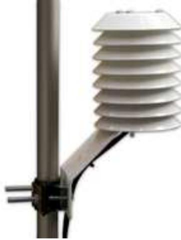
Figura 3.8: Alloggiamento schermato per termocoppia
