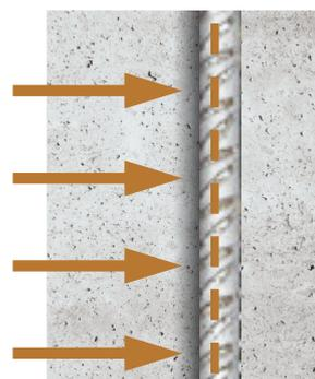
3 / La présence combinée d'humidité et d'oxygène déclenche le phénomène de corrosion des armatures
