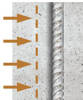
2 / Le front progresse jusqu'à atteindre l'armature. L'alcalinité du béton, qui protège naturellement les armatures de la rouille, est neutralisée
