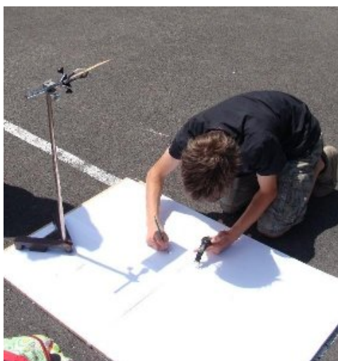
Figure 4. Gnomon, relevé du point lumineux au centre de l'ombre de la planchette
