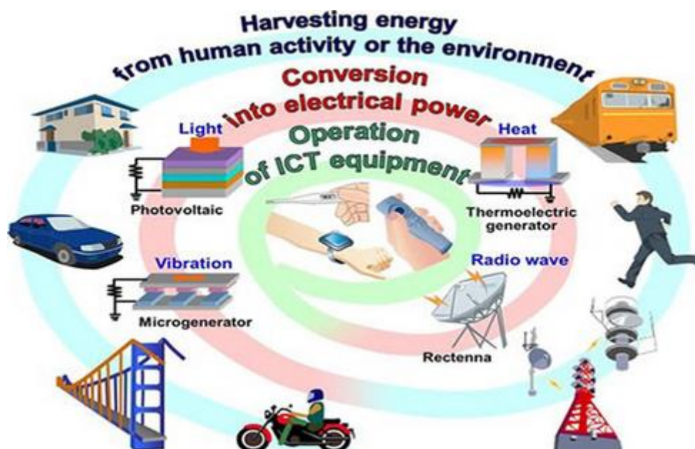
Εικόνα 12: Συγκομιδή ενέργειας και τεχνολογίες συσχέτισης, συμπεριλαμβανομένης της μικρογεννήτριας δόνησης, της ηλιακής φωτοβολταϊκής κυψέλης
