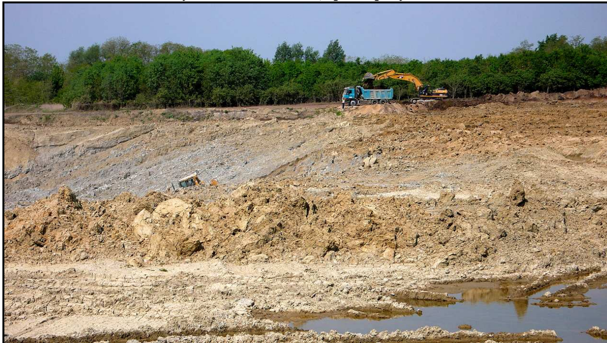
Obr. č.4 – Nakládka suroviny na nákladní vozidlo, vpředu pohyb dozeru ve stěně
