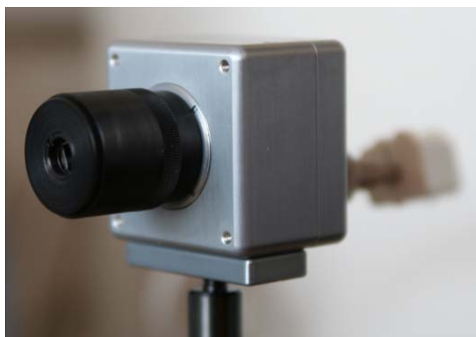
Obr.4: Maticový objektiv pro detekci tvaru vlnoplochy
