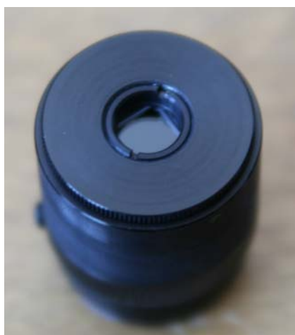
Obr.4: Maticový objektiv pro detekci tvaru vlnoplochy
