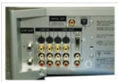
Das Anschlußterminal des Sony Blue ray Recorders BDZ-S77 mit elektrischem und optischem Digital Out
