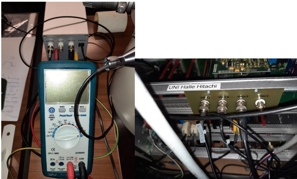
Abb. 17: Monitor (Voltmeter) zur Kontrolle der eingestellten BIAS-Spannung (links) sowie Schaltung des Ausgangssignal des EBIC-Verstärkers auf Video 3 des Messrechners (rechts).
