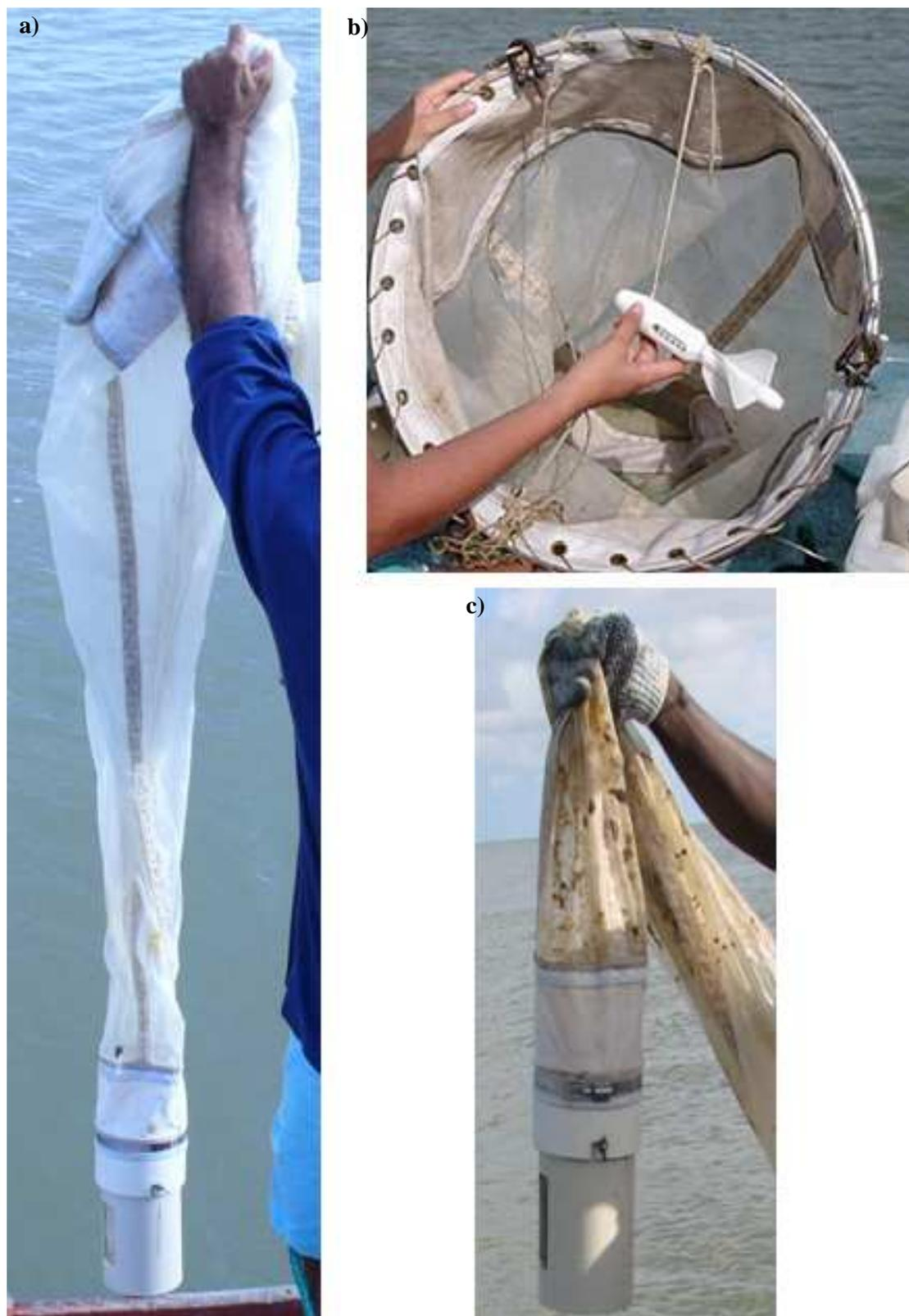
**FIGURA 5:** Rede cônica-cilíndrica utilizada para a obtenção das amostras de zooplâncton no estuário do Rio Marapanim (PA), no período de agosto de 2006 a julho de 2007. (a) Rede em posição vertical; (b) Aro da rede com o fluxômetro *Hydrobios* acoplado em sua abertura; (c) Copo coletor.
