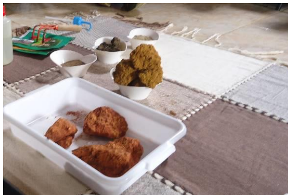
Figura 14 - Teste de consistência do solo
