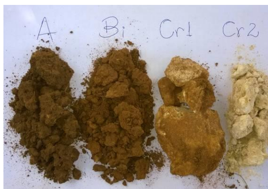
Figura 17 - Amostras representativas dos horizontes do CAMBISSOLO HÁPLICO Ta Eutrófico típico
