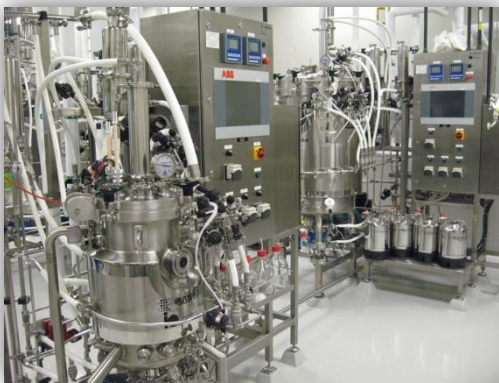
Fig. 27. Bioreactor d'una indústria farmacèutica
