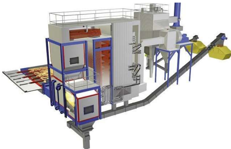
Obrázek 36: Pohled na typové provedení velkého kotle na biomasu
