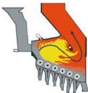
Obrázek 38: Příklad spalovací komory s roštovým topeništěm
