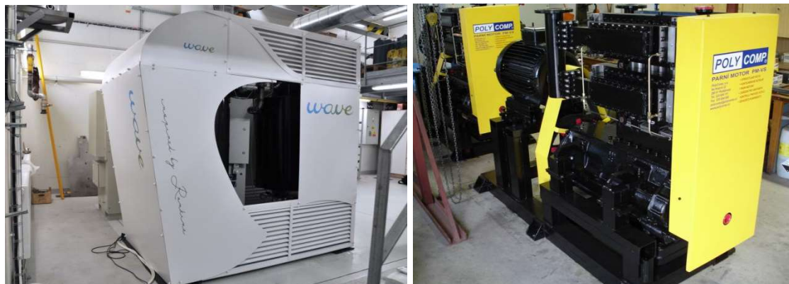
Obrázek 48: Příklady provedení ORC a parního pístového motoru
