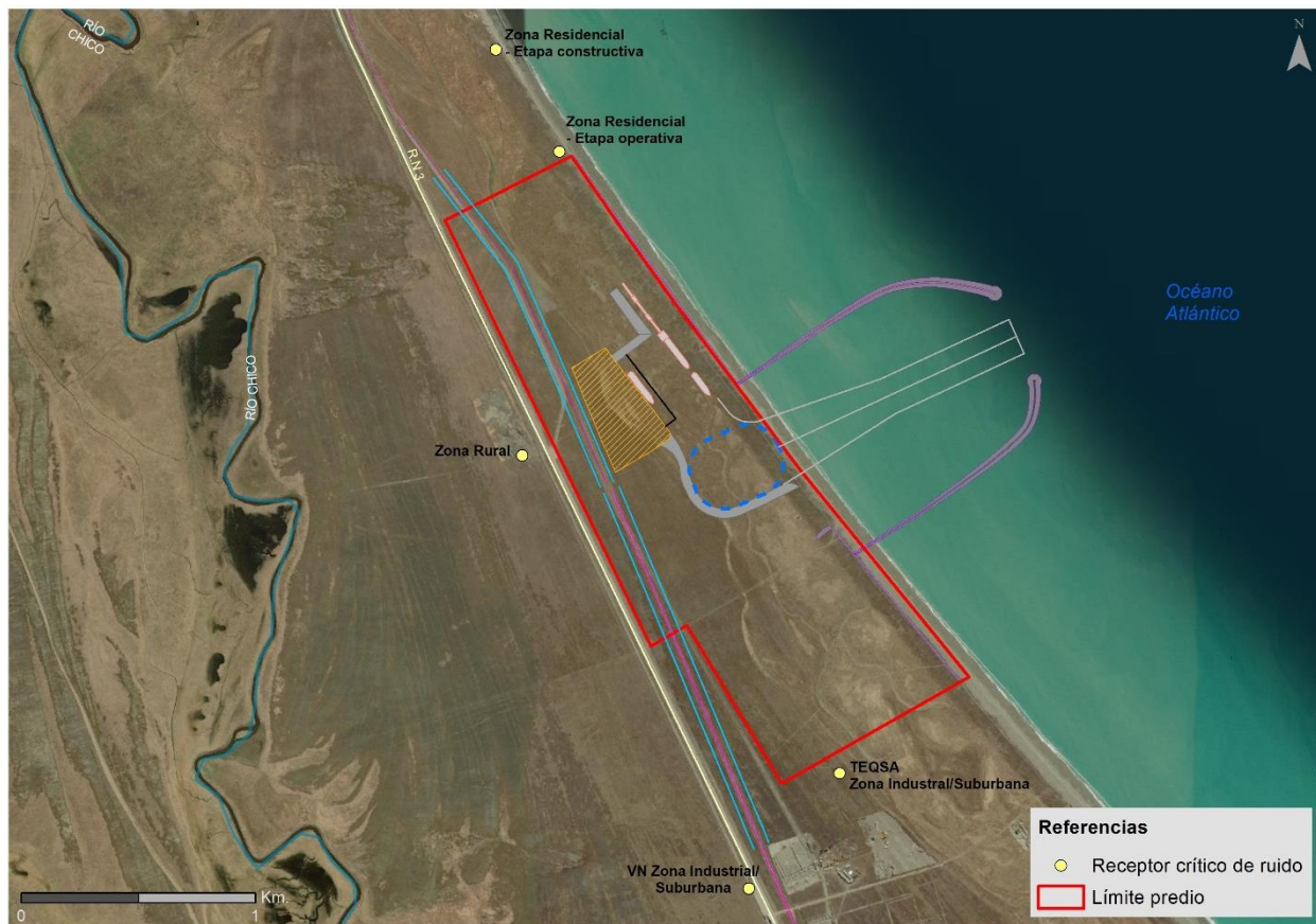
Figura 1. Receptores más próximos al área de implantación del proyecto del potencial impacto acústico que podría provocar la construcción y el funcionamiento del puerto.
