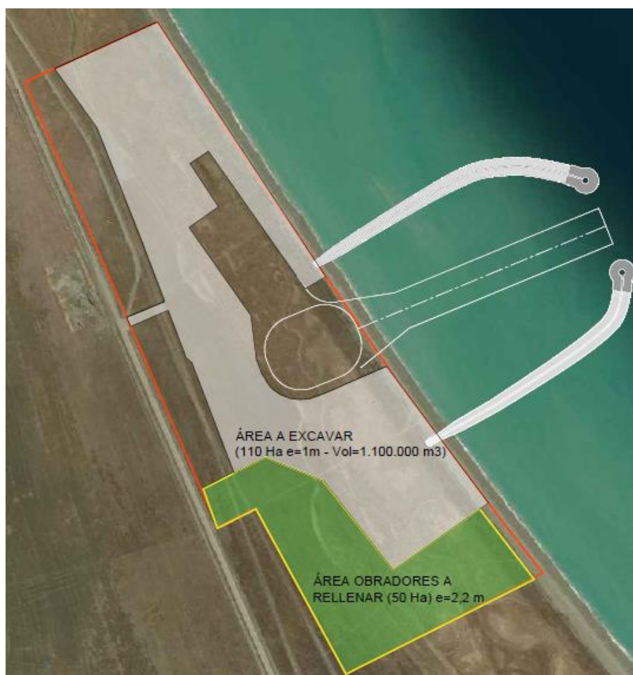
Figura 28. Área a excavar y rellenar (zona de obradores) durante la primera etapa.
