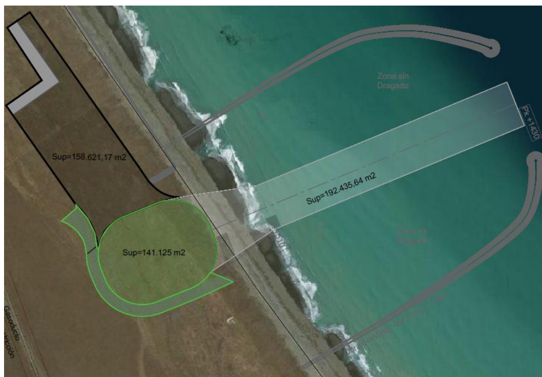
Figura 29. Superficies a excavar/dragar para la construcción del puerto.
