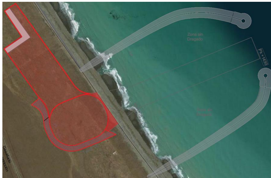
Figura 25. Excavación preliminar para extracción de material de elaboración de bloques de suelo cemento para el núcleo de las obras de abrigo.
