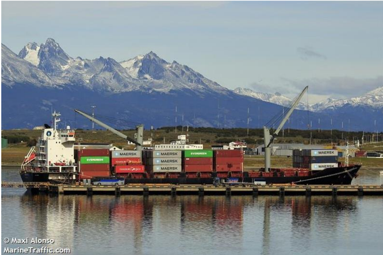
Figura 42. Buque portacontenedores Argentino II (tipo Feeder) operando en Ushuaia con grúas propias.
