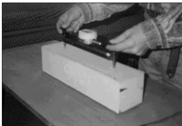
Obr. 1. Meranie zmrašťovania elektronickým deformetrom
