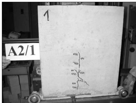
Obr. 10. Tvar trhlin při experimentu
