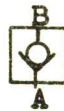
Obr. 4.2.8 vestavný ventil je otevřen ve směru A \rightarrow B a uzavřen ve směru B \rightarrow A
