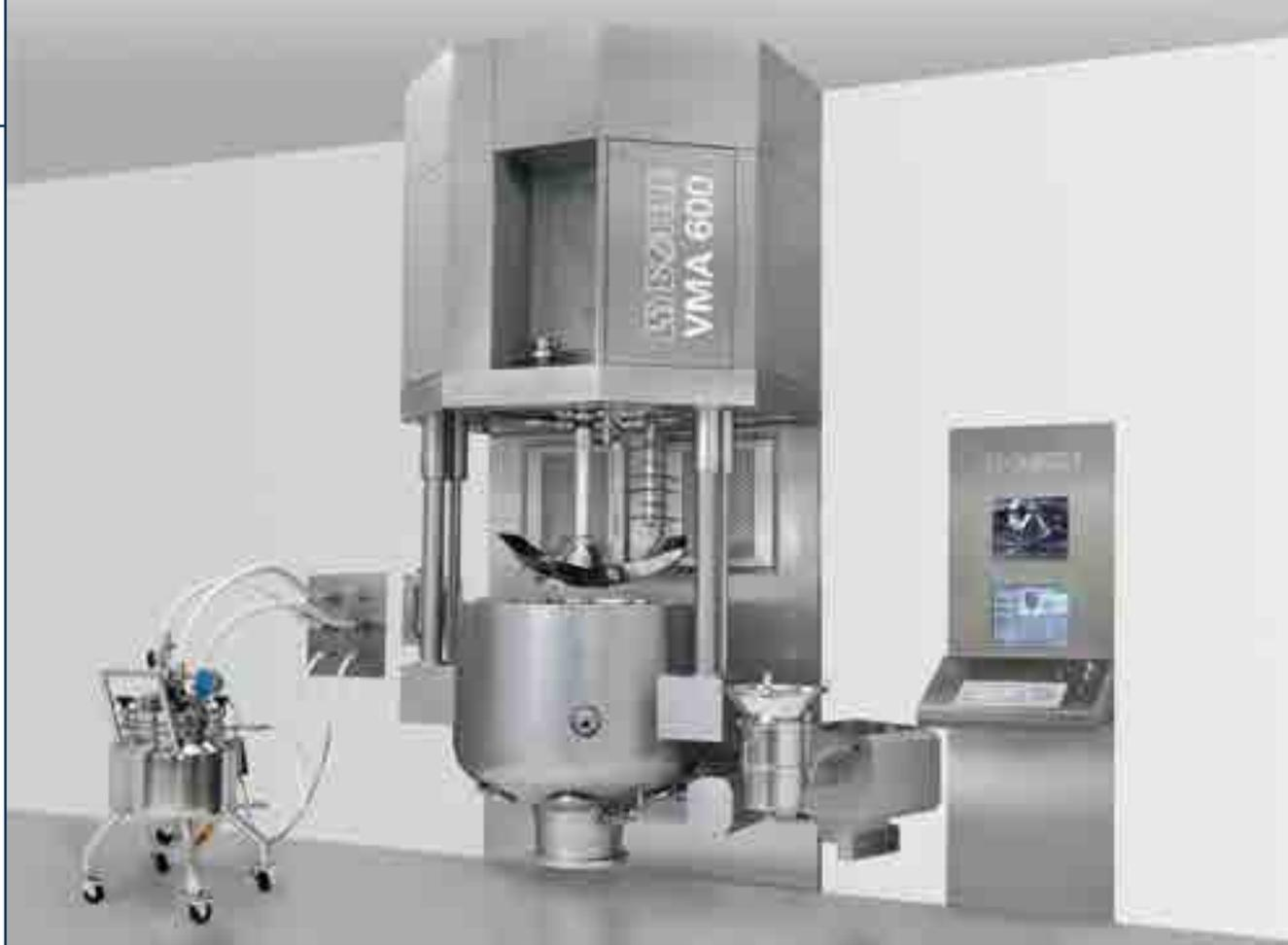
Однокамерный гранулятор VMA представляет собой комплексную систему грануляции и сушки, которая оптимизирована для применения на предприятиях фармацевтической отрасли и производства партий продукции объемом до 960 л. Однокамерный гранулятор Vagumator® предназначен для проведения закрытого беспыльного процесса получения фармацевтических гранул – от загрузки до разгрузки, включая этап измельчения
