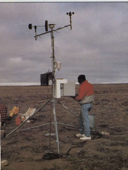
Figure 2 La station météorologique automatique du Service de l'environnement atmosphérique enregistre en permanence les températures du sol à 100, 50, 20 et 10 m et à la surface, ainsi que la température de l'air, la profondeur de la neige, la vitesse du vent et la direction et le rayonnement solaire.
