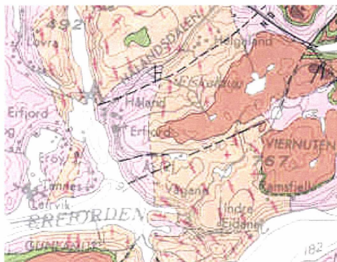
Figur 2.1 Norddalsvassdraget ligg i grensesona mellom det sørnorske grunnfjellsområde og den kaledonske fjellkjedesona. Grunnfjellet består av kvartsdiorittisk og diorittisk gneis, medan skyvedekket består av forskjellige gneisbergartar. Under dette fins det mindre parti med kambrosiluriske bergartar.
